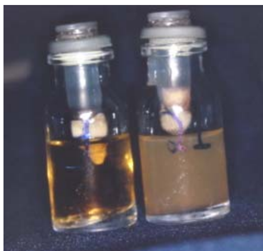
Fig. 3 - Dispositivo de teste com meio de cultura límpido (esquerda) e com turbidez (direita).
