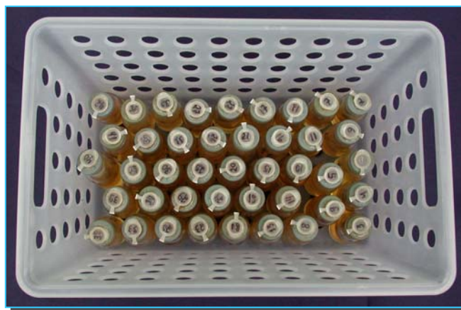
Fig. 2b – Dispositivos de teste em recipiente adaptado para ser levado a estufa bacteriológica.
