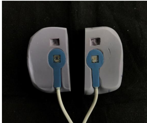
Figura 5 – Dispositivo de referência para o alinhamento do diodo emissor do oxímetro de pulso.
