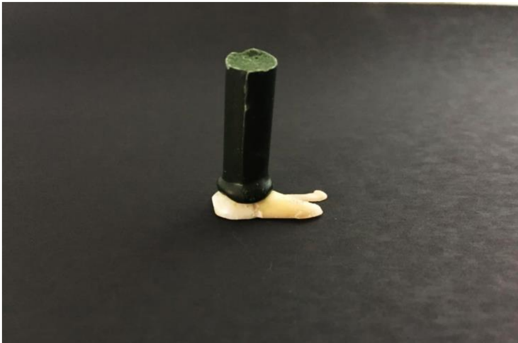
Figura 9 - Face de esmalte-dentina fixado com bastão de godiva.
