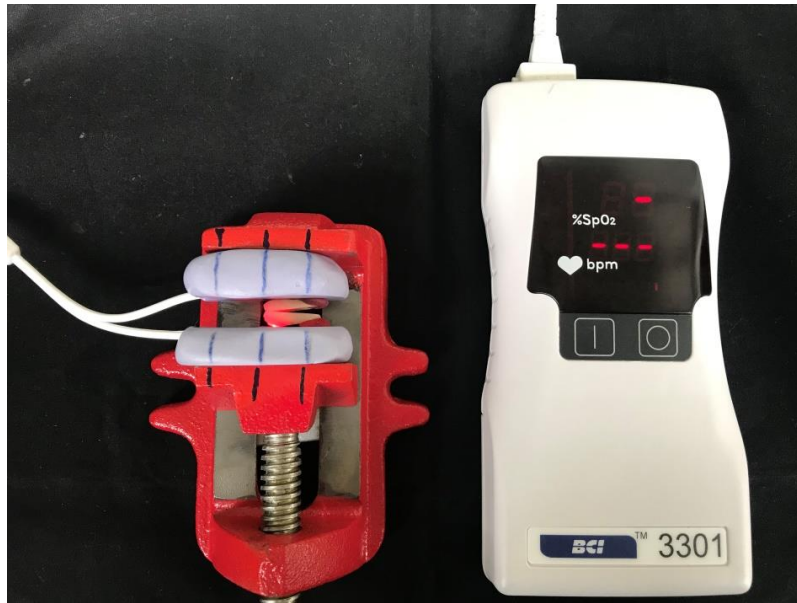
Figura 7 - Mensuração do nível de saturação de oxigênio (%) e BPM apenas com as faces do dente (controle negativo).
