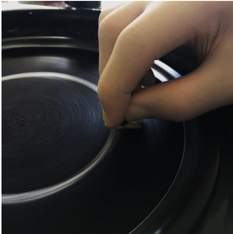
Figura 10 - Face de esmalte-dentina sendo desgastado.
